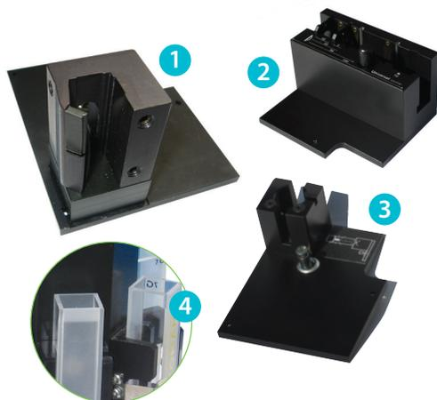
**1 Porte cuve mono-cuve jusqu'à 10 mm de trajet optique :** Il garantit un positionnement rigoureux de tous types de cuvettes. Associé au diaphragme adapté, il permet d'utiliser des micro-cuvettes jusqu'à 50 µl. En option, une version thermostatable est disponible.
