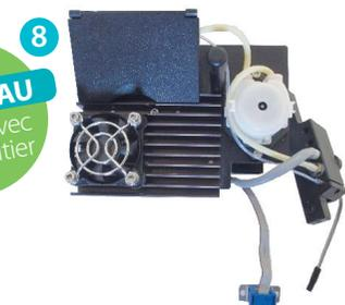
**8 Sipper avec effet Peltier :** Compact, il est équipé d'une pompe péristaltique à cassette intégrée au porte-cuvette et d'un système de régulation de température par module à effet Peltier
