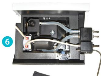
**6 Sipper :** Compact, il est équipé d'une pompe péristaltique à cassette intégrée au porte-cuvette :
