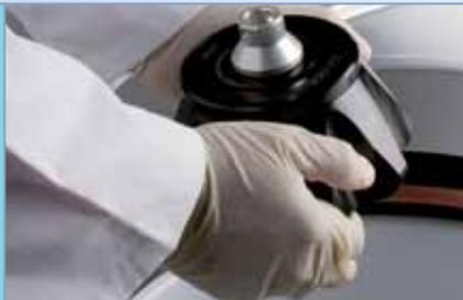
La conception de nos rotors pour ultracentrifugeuses Sorvall facilite et sécurise le chargement des échantillons afin que vous puissiez réaliser des séparations rapides et efficaces.
