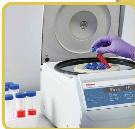
En plus des tubes de prélèvement sanguin de routine, la nacelle angulaire du rotor DualSpin peut accueillir des tubes coniques de 15 ml, prenant en charge les séparations des échantillons de sciences de la vie qui nécessitent une force centrifuge basse, comme le culottage de cellules.
