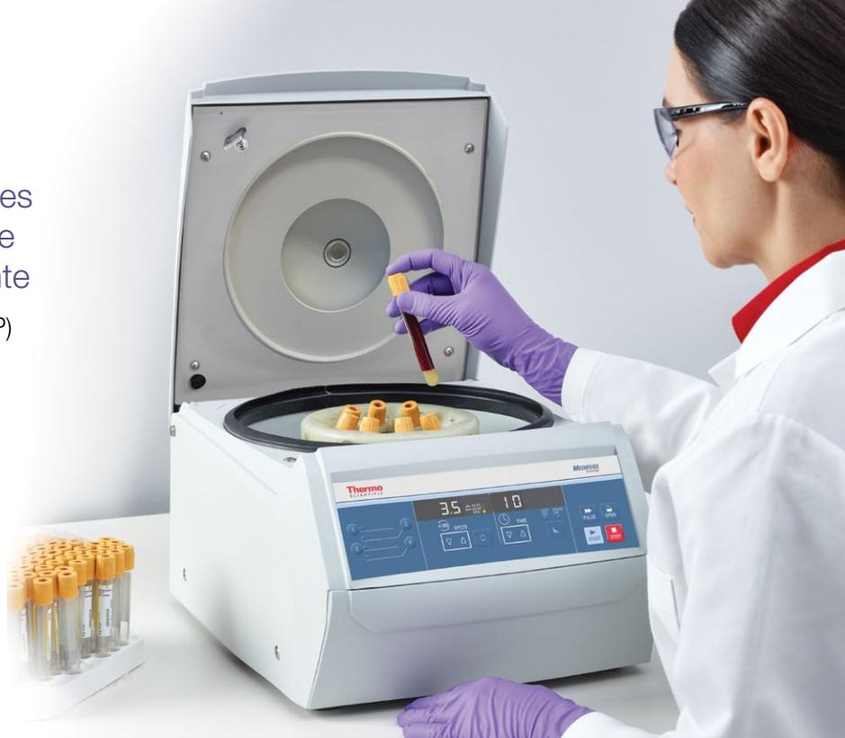
En utilisant les nacelles oscillantes dans le rotor DualSpin, la petite centrifugeuse de paillasse Medifuge est particulièrement bien adaptée à la préparation de sérum à l'aide des tubes en gel. Après la centrifugation, le gel fournit une barrière efficace entre les globules sanguins et le sérum. Ces tubes peuvent ensuite être conservés ou transportés avec un risque de contamination minimal vers un laboratoire pour d'autres tests.
