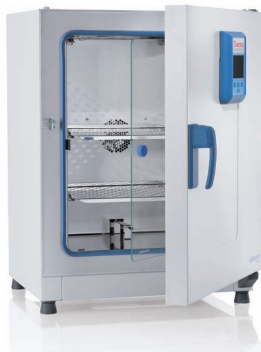
Incubateur microbiologique Thermo Scientific Heratherm Advanced Protocol avec système exclusif de convection double
